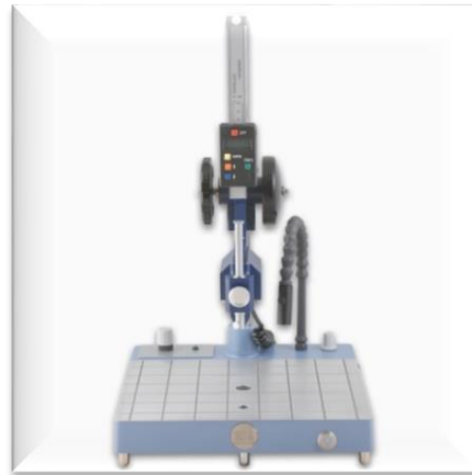
Aparat pentru determinarea punctului de înmuiere inel și bilă (ASTM D36)
