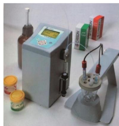
Aparatul este accesorizat cu suport cu agitator magnetic, soluții tampon, electrolit și cablu pentru electrod, electrod Crisolyt pentru măsurarea pH-ului și acidității totale, electrod Pt pentru determinarea SO<sub>2</sub>. Pentru determinarea clorului, aparatul este dotat inclusiv cu suport cu agitator magnetic, electrolit (KNO<sub>3</sub> 1M), cablu, electrod argint combinat 52 60.
