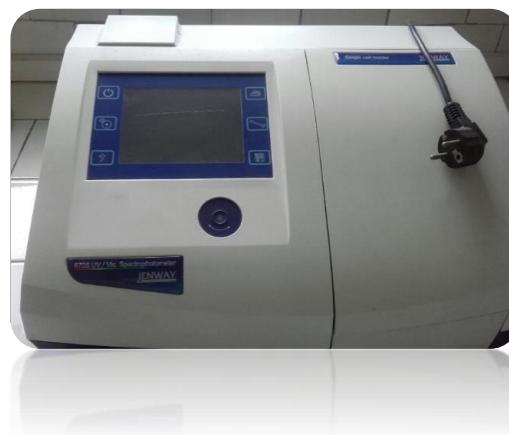
Caracteristicile acestui echipament sunt: Interval lungime de undă 190 - 1100 nm, Rezolutie 0.1 nm, Acuratete  $\pm$  1 nm, Latime de banda spectrală 4 nm.
