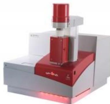
Studiul fenomenelor variază de la desorbție, reacții în fază gaz-solid, descompunere (piroliză, combustie) pentru a determina: analiza compozitiei, conținut de cenușă, carbon, umpluturi, aditivi și efectul lor asupra stabilității termice/ calității materialului/performanței produsului.
