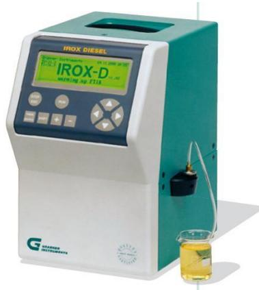
Proprietățile cheie ale motorinei, precum numărul cetanic, proprietățile de cetan index și de distilare sunt determinate cu cea mai mare precizie. IROX Diesel măsoară conținutul de aromatice totale, poliaromatice nucleare și biodiesel.
