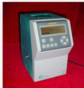
**MINIDIS** este un aparat de distilare atmosferică, ale căruia rezultate de testare se coreleză excelent cu metoda ASTM D86. Datorită designului special al sistemului său de măsurare: dimensiunile miniaturizate ale cupei de testare, coloanei de separare, tubului condensatorului și camerei de condensare.
