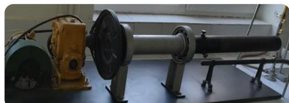
Echipamentul de laborator se poate utiliza pentru decontaminarea termică a diverselor tipuri de soluri contaminate cu produse petroliere lichide.
