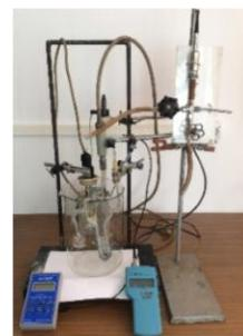
În acest mod se obțin date de echilibru  $P-T-x$ , urmând ca fractia molară  $y$ , în faza vaporii să se determine din ecuația Gibbs-Duhem. Aparatul poate fi utilizat pentru determinarea presiunilor de vaporii a compozițiilor puri sau a amestecurilor lichide, cu valori cuprinse între 10 mmHg și 760 mmHg. Temperatura corespunzătoare stării de echilibru este temperatura din baia de termostatare. În acest mod se obțin date de presiune la temperatură fixată.
