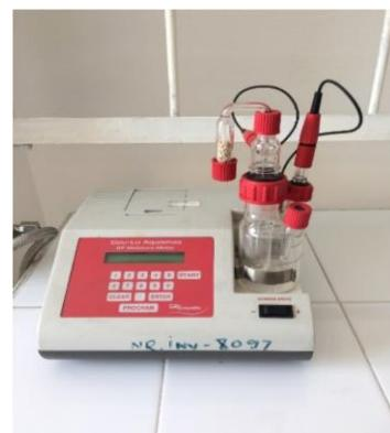
Domeniul de măsurare a conținutului de apă pentru care aparatul a fost proiectat este de la 1 $\mu$ g până la 100mg apă, însă în mod curent aparatul lucrează pentru intervalul 1 $\mu$ g - 10mg apă. Intervalul de umiditate este de 1ppm - 100% apă.
