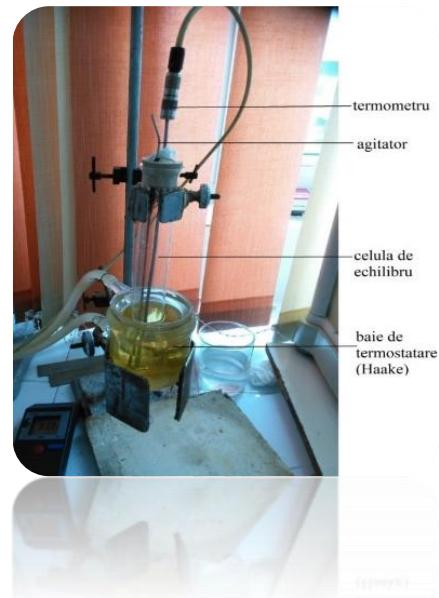
Acest aparat este constituit din, baie de termostatare – criostat Polyscience (figura a) și celula de echilibru senzor de măsurare a temperaturii, sistem de agitare și biuretă (figura b).
