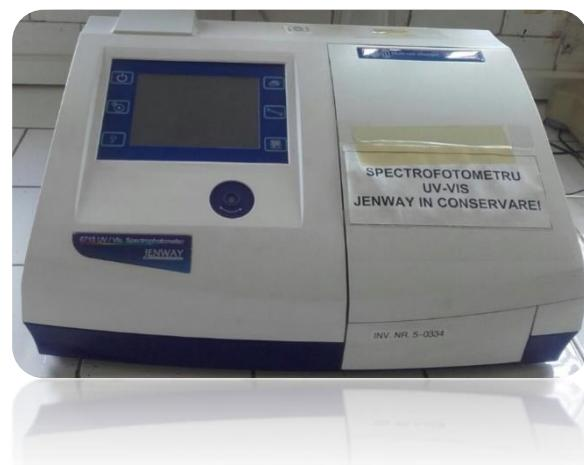
Caracteristicile acestui echipament sunt: Interval lungime de undă 190 - 1100 nm, Rezoluție 0.1 nm, Acuratete  $\pm$  1 nm, Latime de banda spectrală 1.5 nm.
