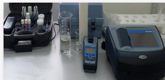
Astfel laboratorul este dotat cu: pH-metre, aparatură Jar-Test, aparat pentru determinarea carbonului organic total, spectrofotometre UV-VIS cu dublu fascicul, oxigenometre, microscop electronic OPTIKA necesar monitorizării microorganismelor aerobe și anaerobe, aparat pentru determinarea consumului biochimic de oxygen- VELP.
