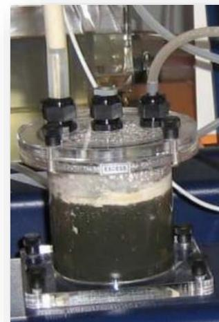
**Micro-pilot plant for aerobic and anaerobic biological treatment/Instalația micropilot de epurare biologică aerobă și anaerobă**
