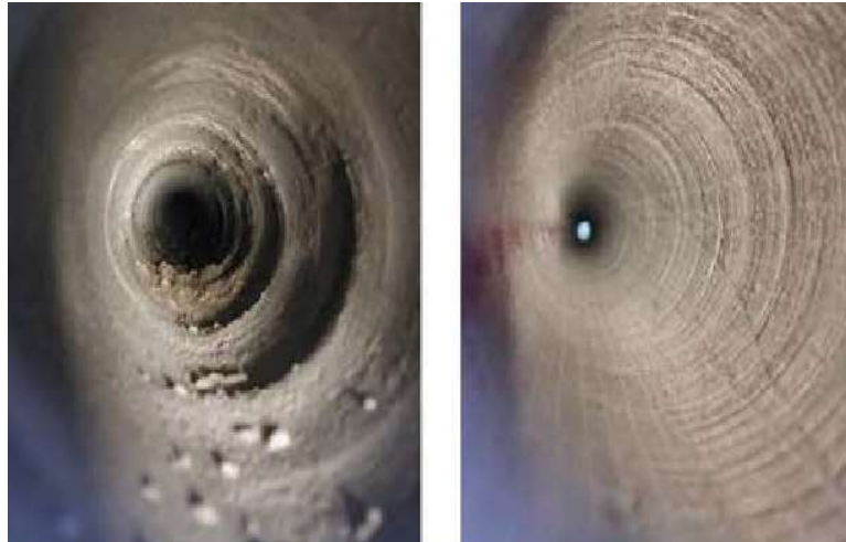
Fig 6.5. Comparație între două găuri de foraj, prima săpată cu motor de fund, iar cea de-a doua cu sistem RSS [6]
