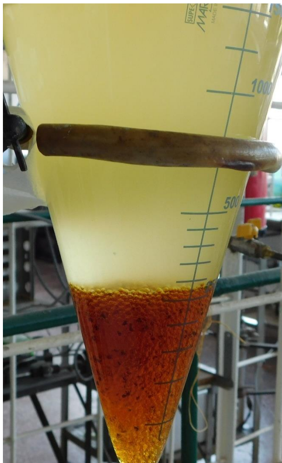
Figura 3.6 Uscare pe silicagel
