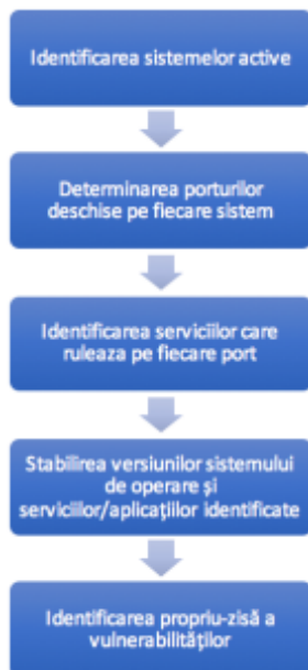
Fig. 4.1 - Pașii aferenți unui algoritm de identificare automată a vulnerabilităților unui sistem informatic
