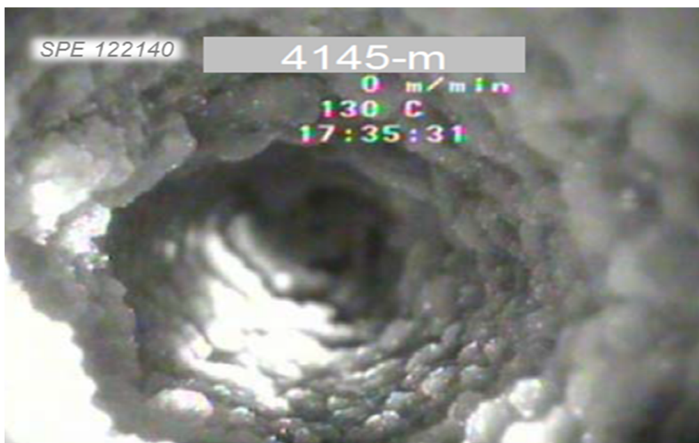
Figura 2.3. Sare depusă pe pereții tubingului [24]
