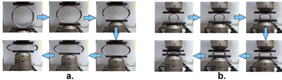
Fig. 5.19. Comportarea la aplatisare a inelelor din material tubular nou pentru: a. probe din oțel P5; b. probe din oțel P91
