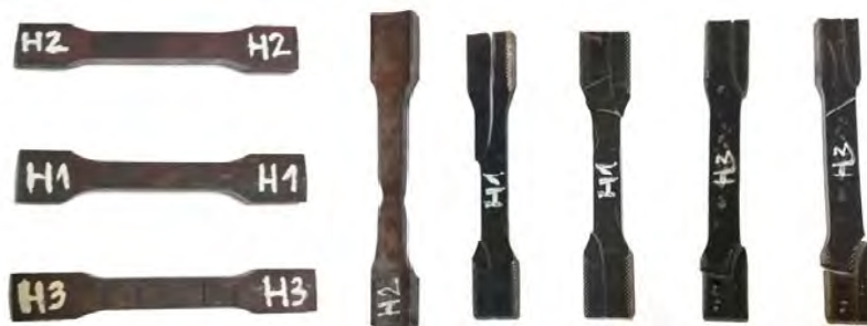
Fig. 5.6. Aspectul epruvetelor prelevate din oțelul P91 înainte și după încercarea la tracțiune
