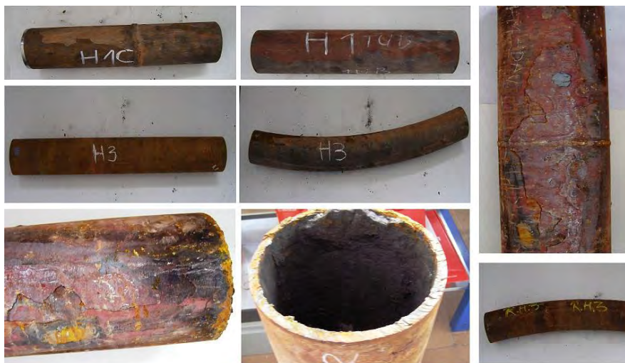
Fig. 5.1. Material tubular provenit din cuptoarele H1 și H3 folosit pentru prelevarea probelor testate
