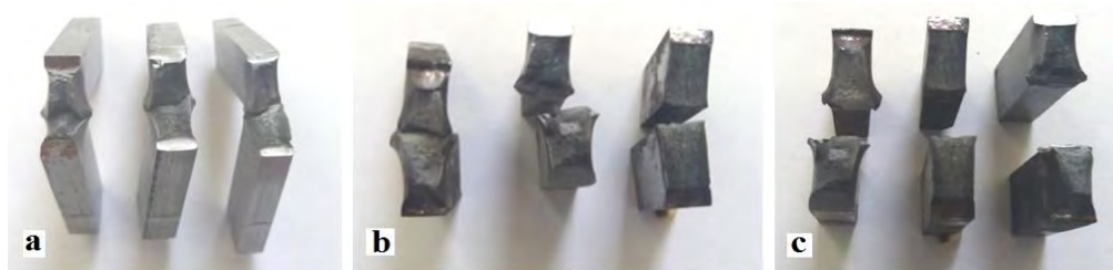
Fig. 5.10. Aspectul suprafețelor de rupere ale epruvetelor din oțelul P91 încercate la încovoiere prin șoc: a) țevă nouă (H2); b) H1; c) H3
